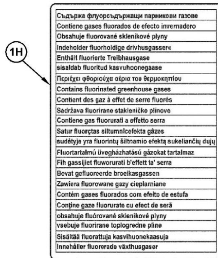
Рисунок 5 g06179807 (1H) На данной наклейке (при наличии) приводится перевод на требуемые языки фразы "Содержит фторсодержащие парниковые газы" согласно нормам и правилам Европейского союза касательно газов, вызывающих парниковый эффект.
